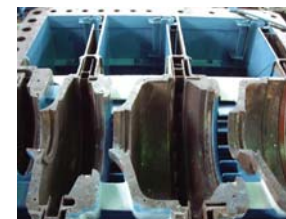
化工厂空压机内腔防腐
